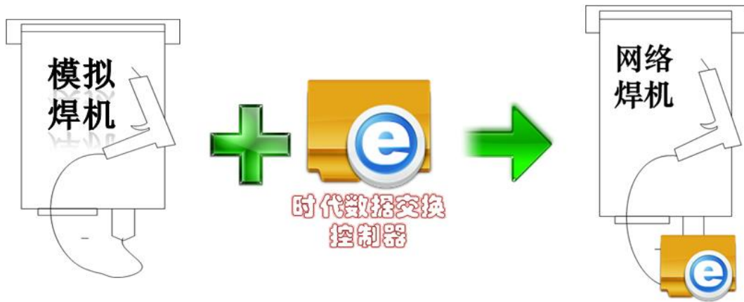
图 2：模拟焊机数字化升级方案
